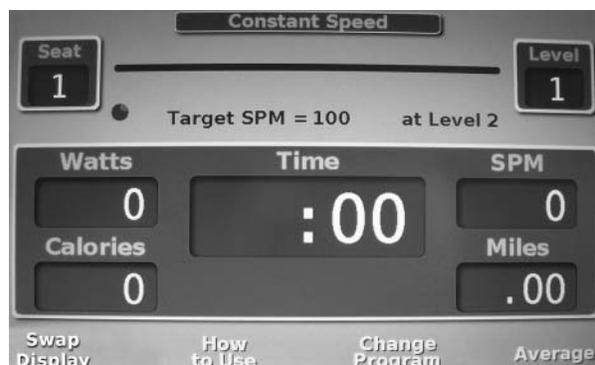
このプログラムは、ユーザーが一定のステップ速度でエクササイズするのに役立ちます。ユーザーはエクササイズを始める前に希望する毎分ステップ数 (SPM) を入力してください。プログラムが、ユーザーのSPMが一定値になるように運動量を調整します。ユーザーのステップ速度がSPM/パラメータを上回るようならば、運動量が増加します。ユーザーのステップ速度がSPM/パラメータを下回るようならば、運動量が減少します。ユーザーはエクササイズ中、いつでもSPMを増減することができます。非常に高速または低速の場合、プログラムはユーザーが一定ステップ速度を保つことができるように最善策を講じます。能力の限界に達すると、メッセージでその旨を知らせます。
