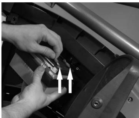
5. 電池を取り外します。新品の電池を取り付けるには、以上の手続きを逆に行ってください。
