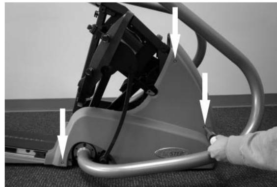
注：前面下部カバーはペダルを機械の後ろ側に動かせば楽に取り外しができます。
