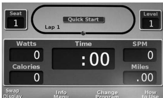
このプログラムはアームハンドルまたはフットペダルを動かすと自動的にスタートします。その際、目標値は飛ばされます。ユーザーは手動で上下の矢印を操作して運動量をお望みの設定値に変えることができます。
