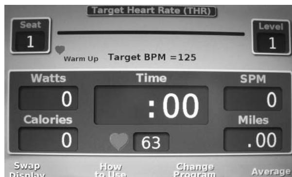
このプログラムは、ユーザーの心拍数が目標の心拍数範囲内におさまるように運動量を調整します。ユーザーはエクササイズを始める前に目標心拍数 (THR) を入力しておきます。目標心拍数は次の方程式で計算されます。[THR = (220 - 年齢) \* X%]。エクササイズの強度は「X%」変数でコントロールされます。「X%」の下限は50で、上限は85です。目標心拍数方程式と心拍数範囲は、米国スポーツ医学会 (ACSM) と米国心臓学会 (AHA) のガイドラインに基づいています。ユーザーは運動中いつでもTHR/パラメータを調整することができます。ウォームアップ段階は、ユーザーの毎分心拍数 (BPM) が目標心拍数の10心拍以内になるまで続きます。注: このプログラムを使用中は心拍数トランスミッターベルトを着用していなければなりません。
