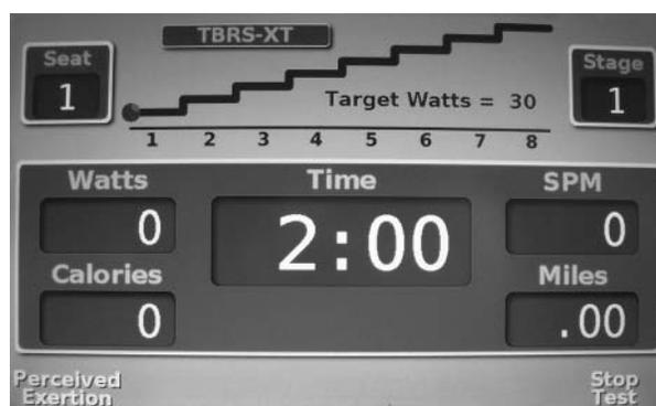
これらのエクササイズ・プロトコル・プログラムは、臨床で管理されるべく設計されています。所定のプログラムが起動されると、8段階の一定パワーモードで2分ごとに段階的にワット数を増加させます。
