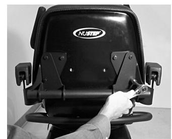
3. Retirez une des vis courtes existante et installez à la place un crochet de rangement 51041 à l'aide d'une vis 51042 plus longue. Répétez cette opération. Ne serrez pas trop les vis.
