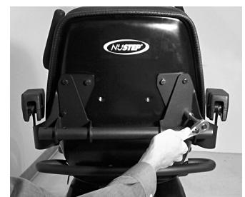
3. Eine alte, kürzere Schraube entfernen und mittels einer neuen, längeren Schraube 51042 einen Befestigungshaken 51041 anbringen. Wiederholen. Die Schrauben nicht überdrehen.
