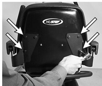
2. Placez les supports de montage du siège 51014 par dessus les supports d'accoudoir, vissez partiellement quatre vis d'accouplement filetées 51039 et serrez-les à 200 +/- 20 inlbs. (23 +/- 2 Nm).
