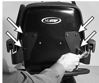
2. シート取付ブラケット # 51014 をヒジ掛けブラケットに合わせ、4 本のフランジヘッドキャップネジ # 51039 を差し込み、トルクレンチ(又はスパナ等)で締めます。
