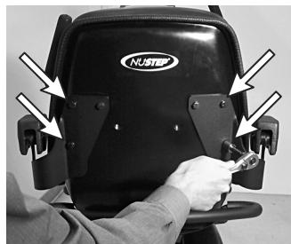
2. Die Sitzmontagehalterung 51014 über den Armlehnenhalterungen positionieren, vier Flanschkopfschrauben 51039 eindrehen und auf 200 +/- 20 inlbs (23 +/- 2 Nm) festziehen.
