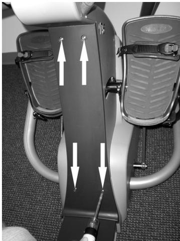
3. Die 2 Schrauben an der rechten oberen Abdeckung entfernen und die Abdeckung vom Rahmen abnehmen.
