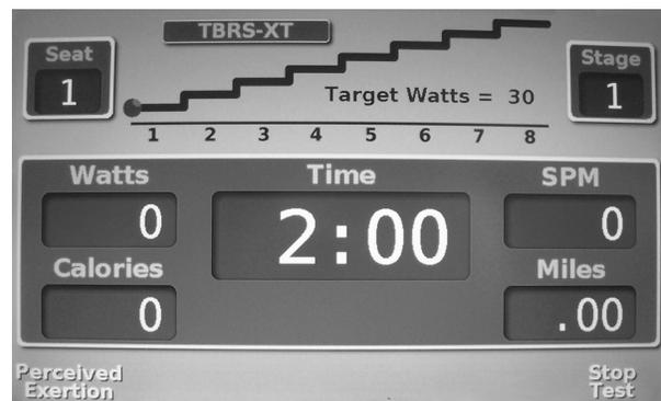
Dies sind Fitness-Protokolle, die zur Anwendung in einer klinischen Umgebung vorgesehen sind. Bei Aktivierung dieser Programme ändern die Protokolle die Wattzahl alle zwei Minuten in einem Konstantleistungsmodus für acht Stufen.
