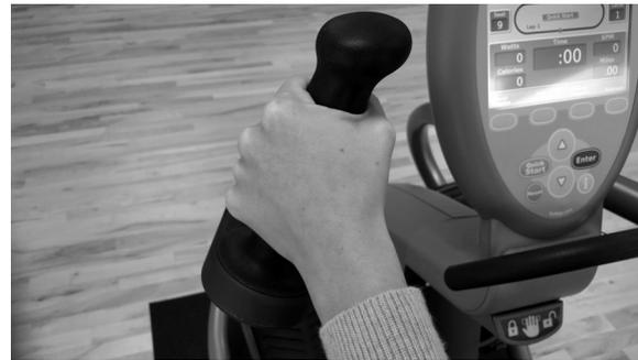
2. Um die Arme und Pedale zu sperren, drücken Sie die StrideLock-Taste. Drücken oder ziehen Sie den Trainingsarmgriff, um zu prüfen, ob die Sperre eingerückt ist.
