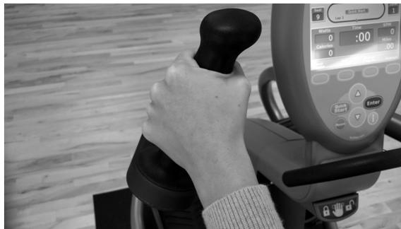
2. Per bloccare manubri e pedali, premere il pulsante StrideLock. Verificare che il blocco sia attivo spingendo o tirando una delle impugnature dei manubri superiori.
