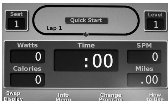
Questo programma si avvia automaticamente semplicemente muovendo le maniglie del braccio o i pedali del piede. Evita anche di inserire le informazioni sull'obiettivo. L'utente può cambiare manualmente il carico di lavoro come desiderato utilizzando i pulsanti freccia su e giù.
