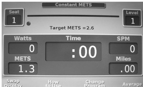
このプログラムでは、一定の労力でエクササイズできます。エクササイズ開始の前に、希望するワット数レベルまたはMETsレベルを入力します。このプログラムでは、ユーザーのステップ速度とステップ長に応じて負荷を調整し、ワット数またはMETレベルを定率に維持します。ユーザーのステップ速度と力によってワット数またはMETレベルが指定した入力値を上回ると、負荷レベルが減少します。ユーザーのステップ速度と力によってワット数またはMETレベルが指定した入力値を下回ると、負荷レベルが増加します。エクササイズ中にいつでもワット数/METsパラメータを調整できます。注:指定した入力値よりも速く、多くの力を出している場合、または指定された入力値よりも遅く、少ない力を出している場合、ポップアップが表示されてユーザーに警告します。
