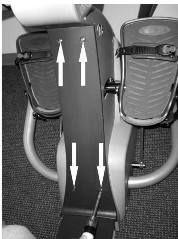
3. 右上部カバーから2本のネジを外し、フレームからカバーを取り外します。
