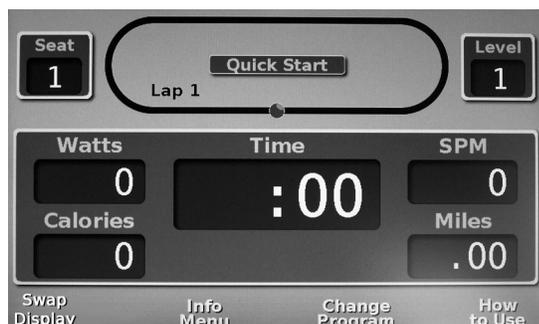
このプログラムは、アームハンドルまたはフットペダルを動かすだけで自動的に起動します。また、目標情報の入力も省略します。上下の矢印ボタンを使用して、必要に応じて負荷を手動で変更できます。
