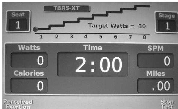
これらの運動プロトコルプログラムは、臨床環境で実施するように設計されています。これらのプログラムが有効になっている場合、プロトコルは、8段階の定電力モードで2分ごとにワット数を増加させます。
